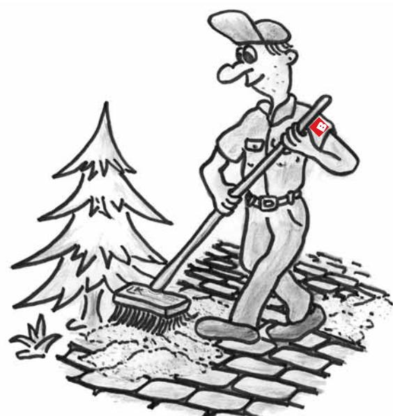
Plochu opětovně zapískovat křemičitým pískem, tak aby výška křemičitého písku ve spárách dosahovala alespoň 2/3 výšky kamene. Tímto předejdeme případnému uvolňování a vzájemnému poškozování kamenů.
